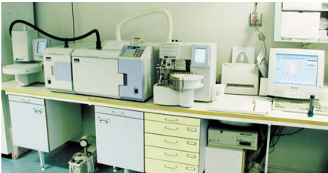
Kuva 1. Lahden tutkimuslaboratorioon hankittiin vuonna 2000 Perkin Elmerin ATD/GC/MS- laitteisto ulkoilman VOC- yhdisteiden määrittämistä varten.
