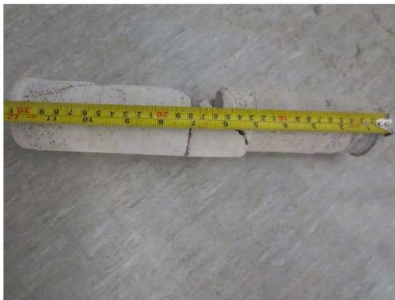
Kuva 3. Sokkelirakenne sisältä ulospäin. 200 mm Siporex, 120 mm betoni
