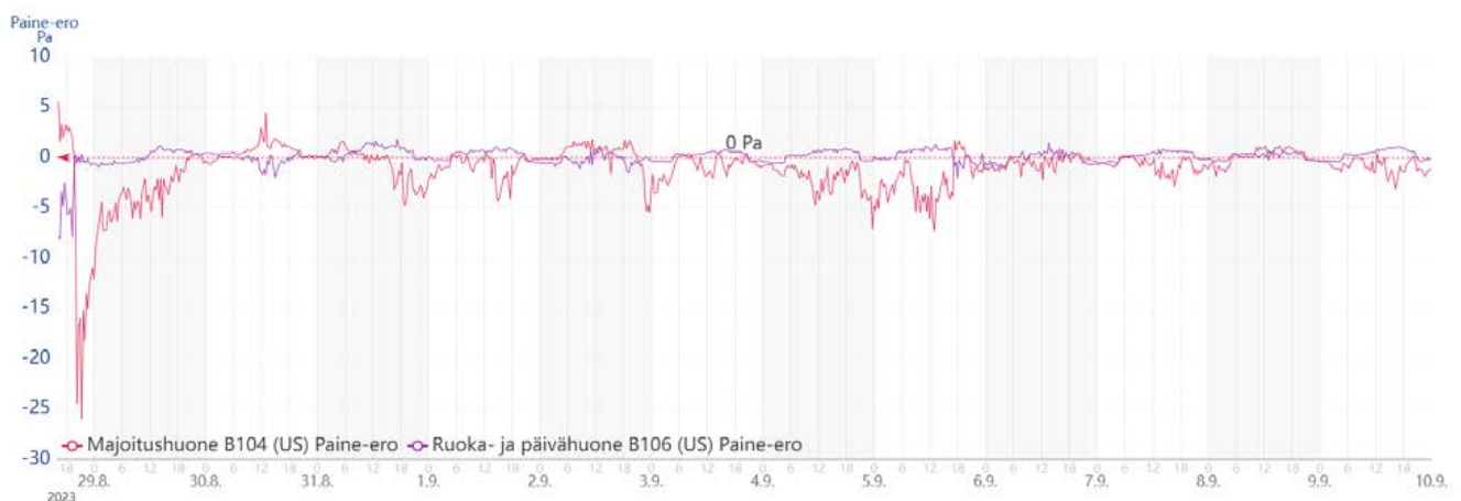
Kuva 40. Ensimmäisen kerroksen ja ulkoilman välinen paine-eroseuranta 28.8.-10.9.2023
