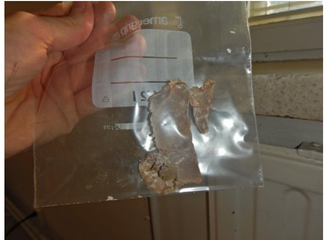
Kuva 16. ASB.15 Kellarin päivähuoneen B005, ikkunapenkin alapinnan valupaperi ei sisällä asbestia
