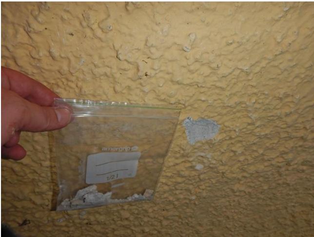
Kuva 7. ASB.06 Julkisivun keltainen maali + rappaus ei sisällä asbestia
