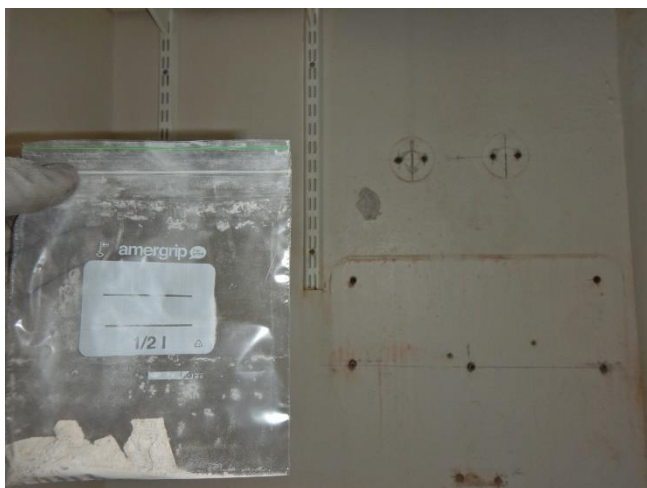
Kuva 13. ASB.12 Siivouskomeron B116 seinämaali + rappaus ei sisällä asbestia
