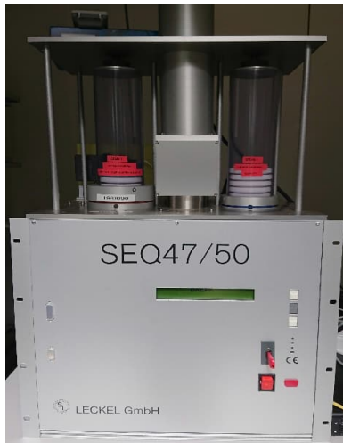
Kuvat 8 - 9. Leckel SEQ 47/50-hiukkaskeräin ja näytteiden keräyksessä käytettyjä suodattimia.
