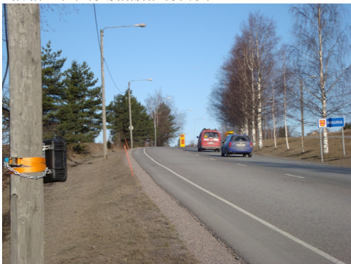
Kuva 1. SDR-mikroaaltolaite asennetaan tien reunaan, noin metrin korkeudelle ajoradasta. Vilkasliikenteisillä kohteilla asennuskorkeus on huomattavasti suurempi, jotta laite rekisteröi liikennettä paremmin myös uloimpana olevalta kaistalta.
