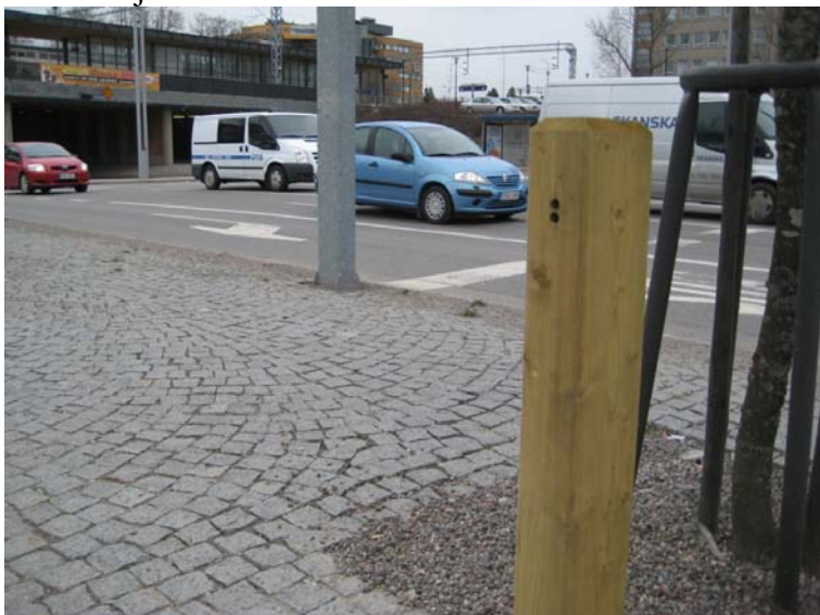
Kuva 2. Puupylvään toisessa aukossa on pyro. Toinen aukko ei ole käytössä.
