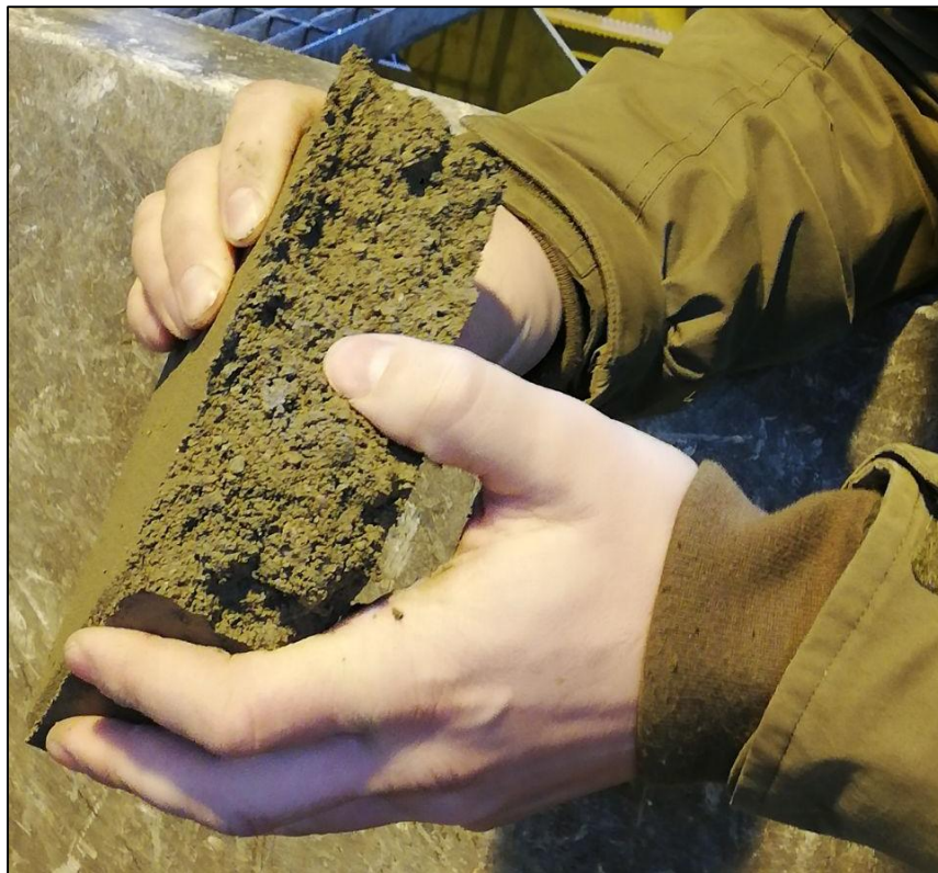
KUVA 1. Tehdasvalmistetun pihakiven koostumus tärytyksen jälkeen
