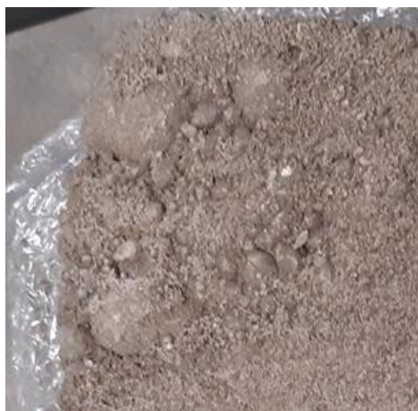
KUVA 6. Palloutunutta massaa valmiissa laatussa
