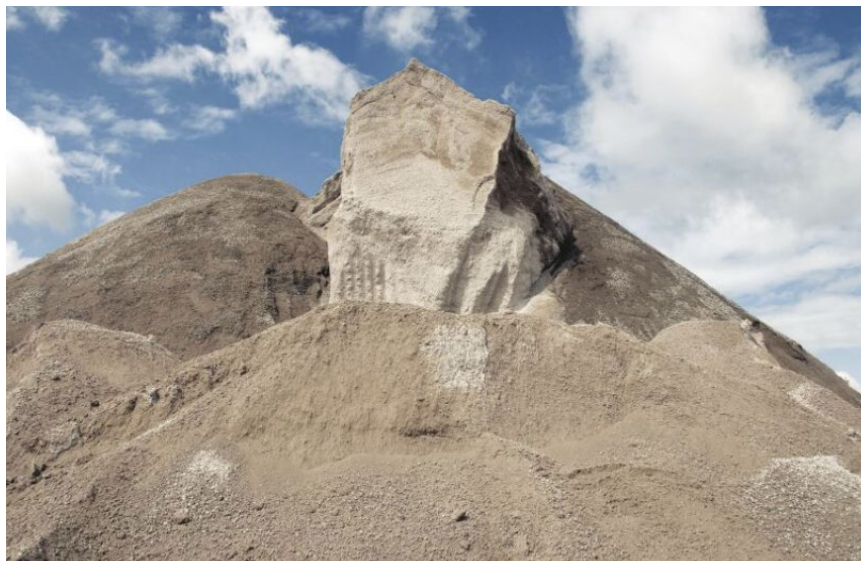
Kuva 3. 0-pohjaisen betonimurskeen varastokasa. Sitoutumisreaktioiden johdosta hienoaines aiheuttaa kasaan lähes pystysuoria leikkauspintoja
