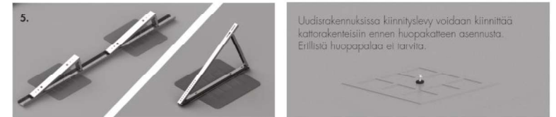
Havainnekuva paneelin kiinnityksestä kiinnityslevyn avulla huopakattoon (Orima)
