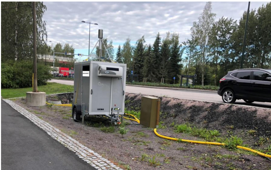
Kuva 10. Hulevesien seurannassa käytetty uudenlainen reaaliaikainen alkuaineanalyysointilaitteisto Merituulentien pilottikohteessa. Kuva: Toni Laurila, Sensmet Oy.
