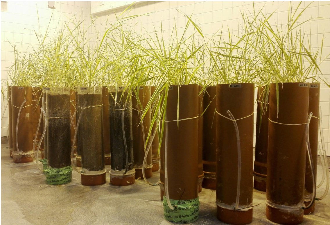
Kuva 6. Helsingin yliopiston toteuttaman lysimetrikokeen koasetelma.
