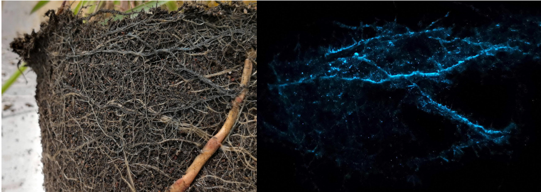
Kuva 7. Lähikuva koeastiasta, johon on lisätty pimeässä sinisenä hohtavaa mikromuovia, minkä ansiosta muovin kulkua voitiin tarkkailla biosuodatusrakenteissa. Vasemmalla valossa otettu, oikealla valot sammutettuna otettu kuva.
