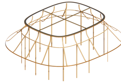
Kantava rakenne - puurakenteinen kehä
